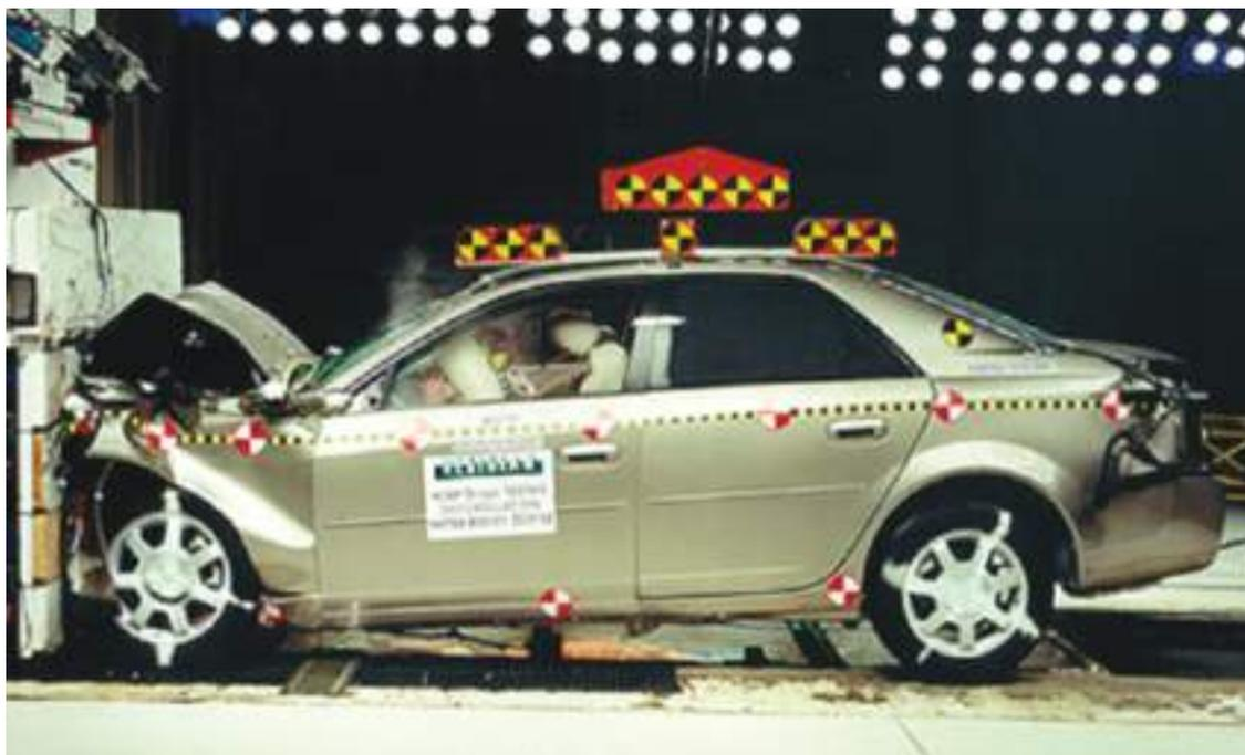
Figura 18 - Teste de colisão frontal de um automóvel<sup>1</sup>.
