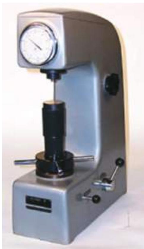
Figura 28 - Identador Rockwell<sup>2</sup>
